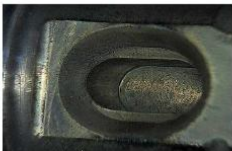
Рисунок 2: Отливка после термического снятия заусенцев. «Обгорели» только заусенцы, т.е. были удалены.
